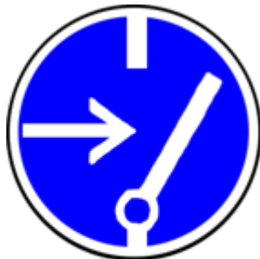
M014 Vor Arbeiten freischalten
